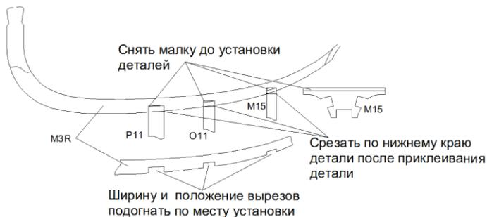
6.30. Подгоните положение верхнего ригеля в соответствии с рисунком справа и Рис. 68, 69 фото инструкции. Передний конец ригеля необходимо подогнать по месту так, чтобы его деревянная часть лежала встык с княвдигедом, а латунная накладка 8 лежала встык с накладкой 20 как на Рис. 68 и на обложке фото инструкции. Для плотного прилегания ригеля к корпусу подрежьте верхний шерстрек и планширь спереди кат-балки (Рис. 51, 52).
